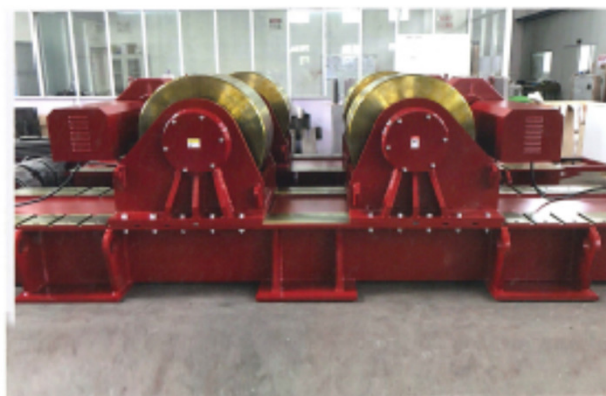
Rodillo de ruedas de acero de 500 toneladas
