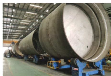
2 conjuntos de unidades de accionamiento con rotación síncrona
