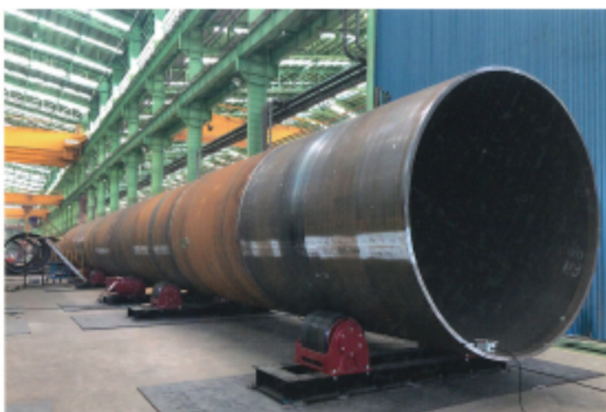
Línea en tierra de 200 toneladas
