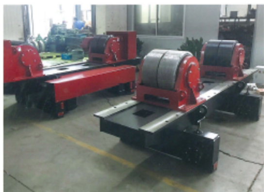
Virador arenador de 120 toneladas
