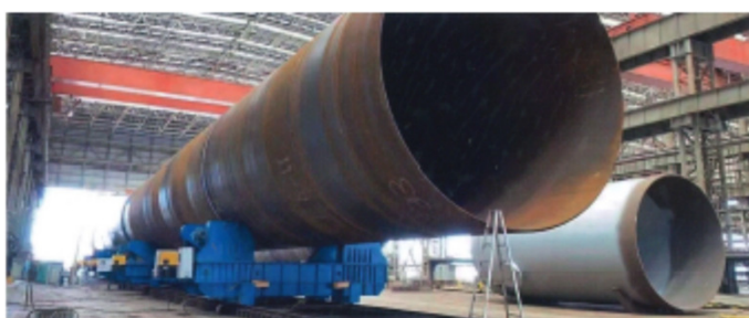
Subida y bajada hidráulica de 200 toneladas
