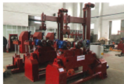
Girador de carrete para soldadura en codo
