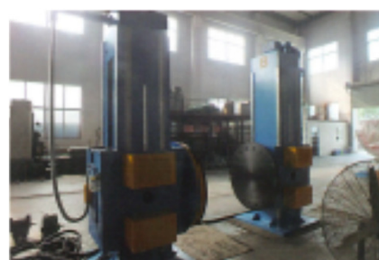
Posicionador de dos columnas
